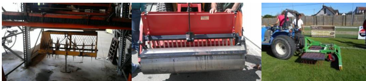
Matériel d'entretien de pelouses sportives (de gauche à droite : Aérateur à lames, re garnisseur à disques, « peigne à gazon »)
