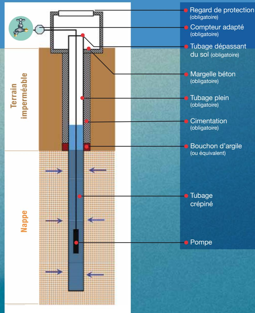
Si le captage est abandonné, il est nécessaire de le reboucher selon les normes (gravier propre surmonté de béton), sinon il peut constituer un point de contamination de la nappe.
